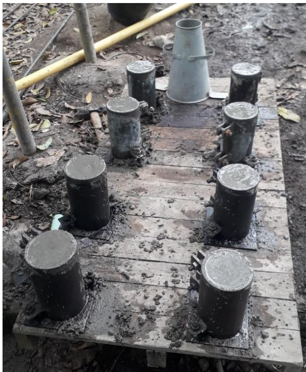
Imagen 10 Toma de cilindros de concreto para posterior ensayo.
