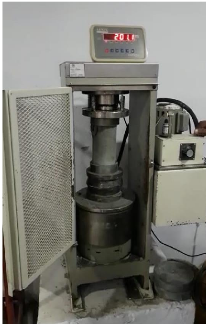
Imagen 11 Ensayo de compresión simple para cilindros de concreto.
