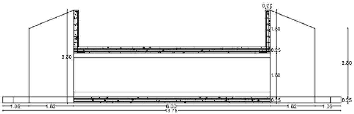
Figura 16. Corte transversal box culvert Fuente: Planos estructurales
