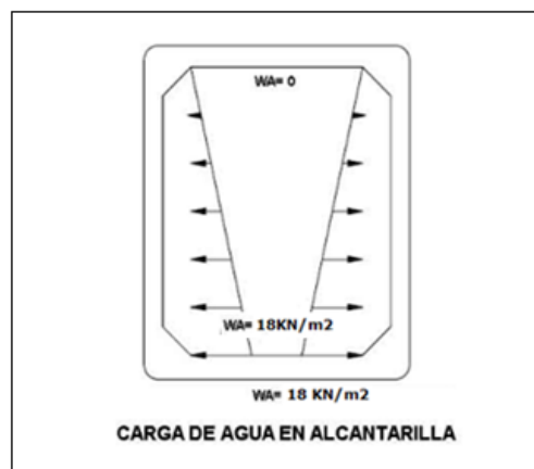
Figura 6. Carga de agua en alcantarilla (WA) Fuente: Elaboración propia
