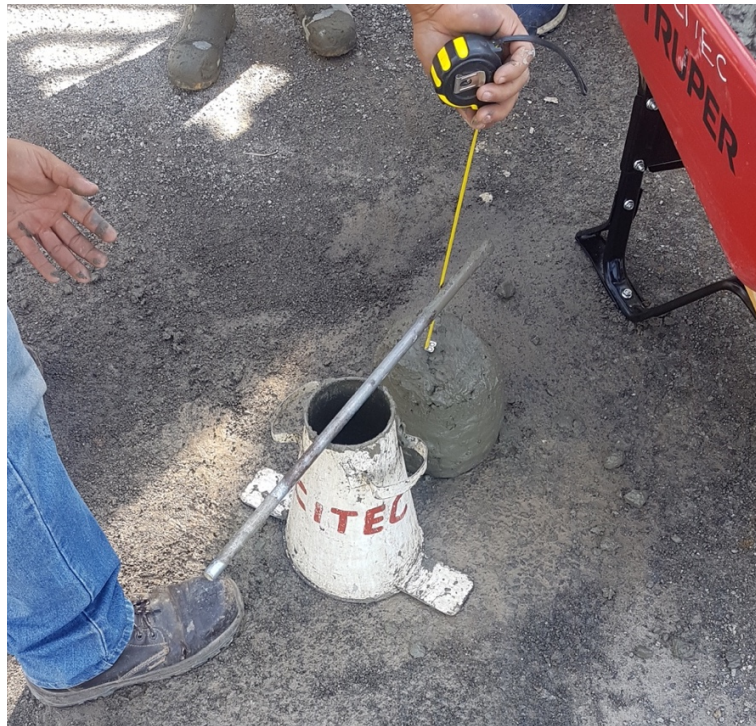
Figura 34. Revisión de asentamiento
