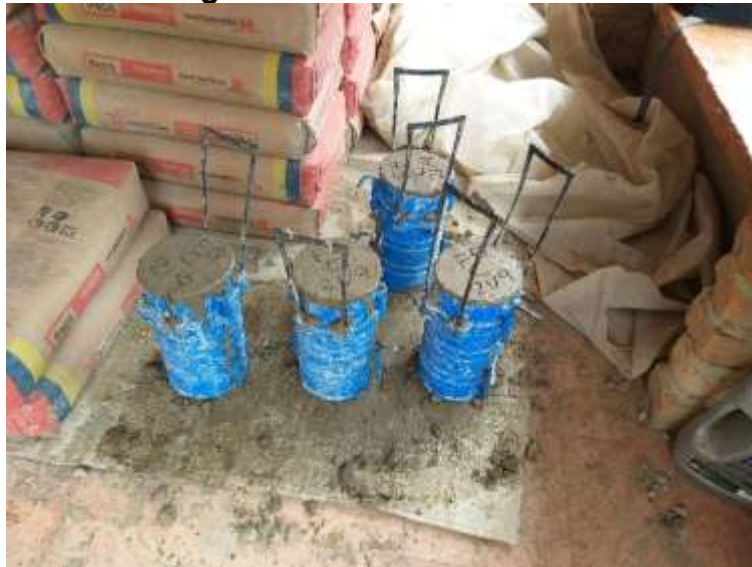
Figura 15 Toma de cilindros
