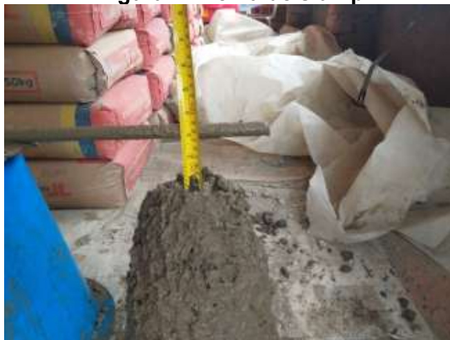
Figura 14 Toma de slump
