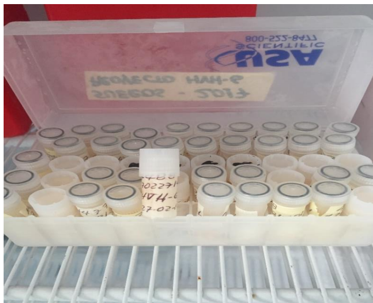
Figura 4. Sistema de Almacenamiento de muestras. La imagen muestra crioviales de 1.5 ml, donde se almacenaron 0.8 ml de muestras de suero y plasma, los cuales fueron codificados y almacenados a -20^{\circ}\text{C} , hasta su procesamiento en el Laboratorio de Inmunología y Biología Molecular de la Universidad del Cauca.
