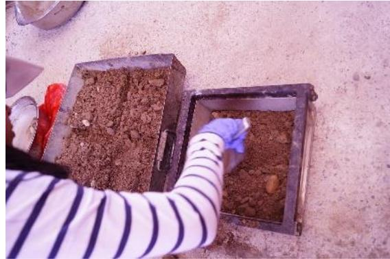
Fotografía 14. Conformación primera capa de material granular.
