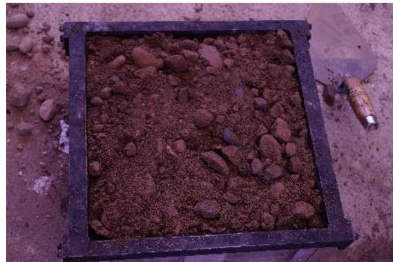
Fotografía 16. Conformación segunda capa de material granular.
