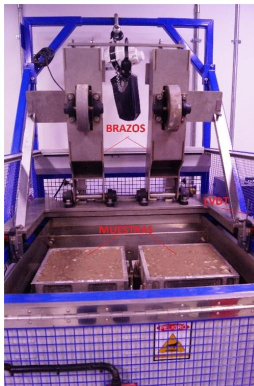
Fotografía 10. Equipo de ensayo LWT
