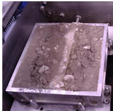
Fotografía 24. Material reforzado después de ensayo.
