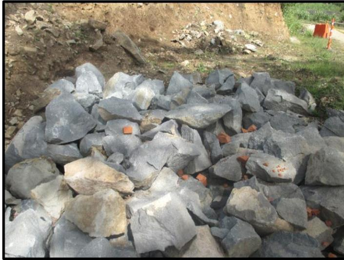
**Figura 1 Rajón utilizado para estabilización de suelos blandos.**
