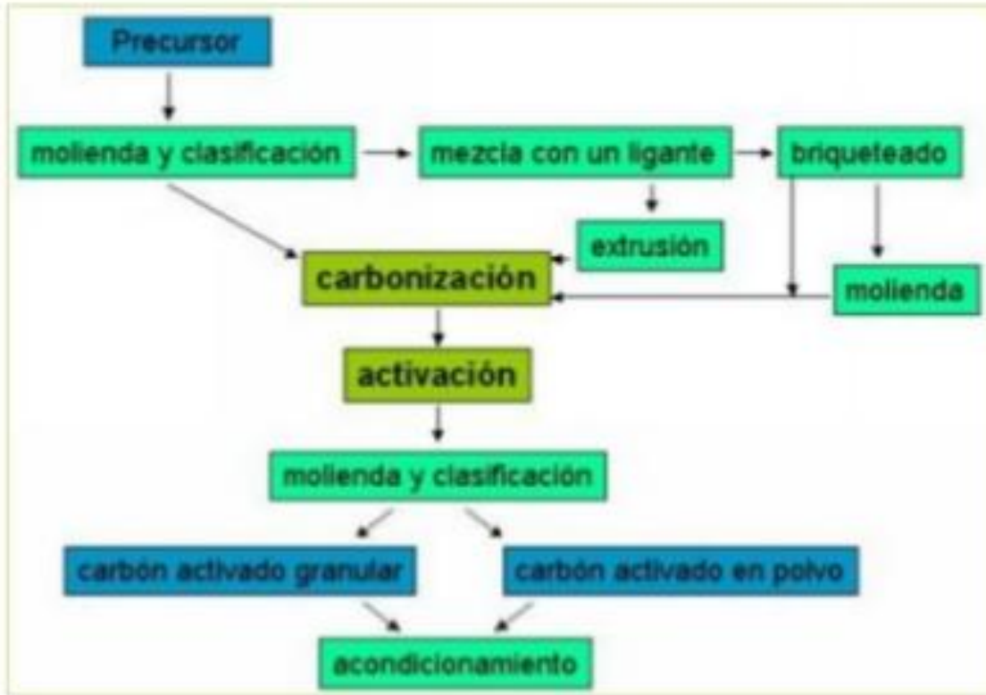
Figura 2. Diagrama de los diferentes procesos que pueden tener lugar en la activación térmica.
