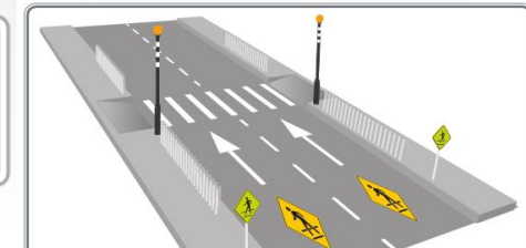
Figura 6.1-2 Paso Cebra en Tramo de Vía
