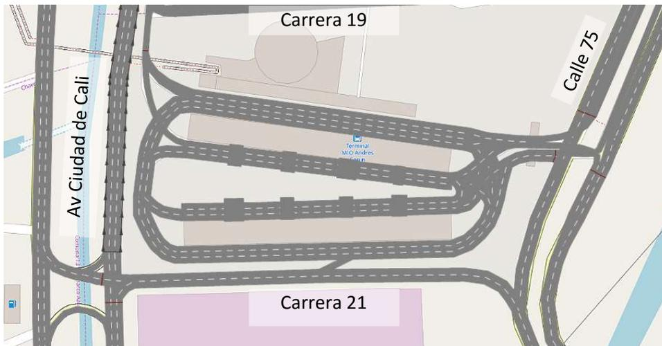
**Figura 51** – Red vial del modelo en VISSIM.
