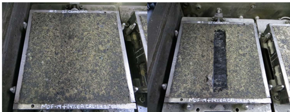
Figura 32. Muestras antes y después del ensayo deformación plástica Cemento 2%
