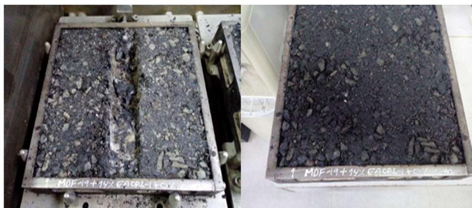
Figura 28. Muestras antes y después del ensayo deformación plástica Cemento 0%
