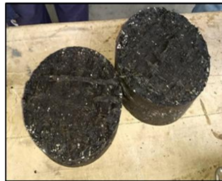
Fotografía 31. Rotura de cuerpo de prueba. Fuente: Esta investigación.
