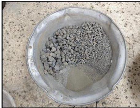
Fotografía 5. Distribución de cantidades de agregado. Fuente: Esta investigación.
