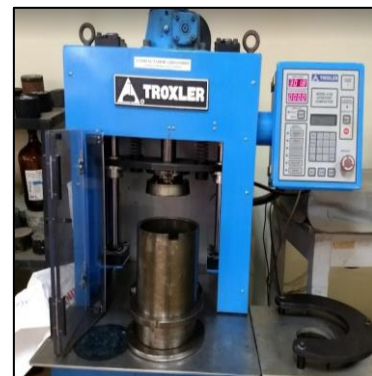
Fotografía 12. Compactación de capa inferior en compactador giratorio. Fuente: Esta investigación.
