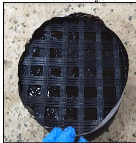
Fotografía 22. Instalación de geomalla. Fuente: Esta investigación.
