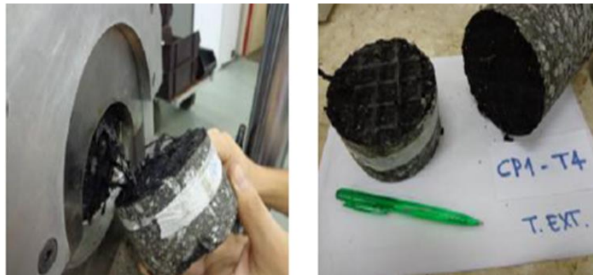
Figura 9. Ruptura por corte mediante el equipo Leutner. Fuente: Guimarães, 2013.
