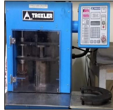
Fotografía 9. Compactación de capa inferior en compactador giratorio. Fuente: Esta investigación.
