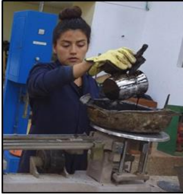
Fotografía 7. Adición de cemento asfáltico. Fuente: Esta investigación.
