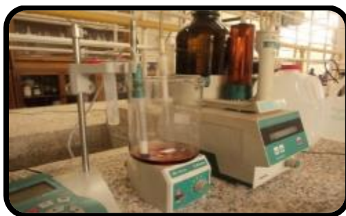
Figura 3.4. Montaje utilizado para controlar la acidez de la solución por adición del \text{NH}_4\text{OH} , donde se observa un pH-metro (lado izquierdo), un agitador magnético (centro) y el dosificador (lado derecho)
