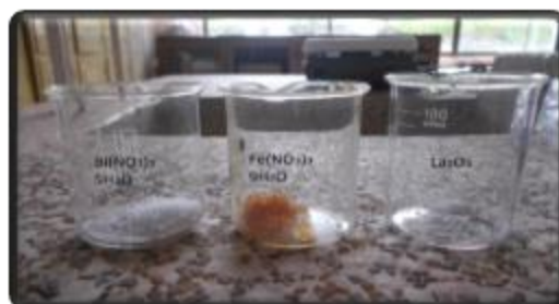
Figura 3.1. Precursores del sistema \text{Bi}_{1-x}\text{La}_x\text{FeO}_3 ( x = 0.05 - 0.2 ). De izquierda a derecha se encuentra el \text{Bi}(\text{NO}_3)_3 \cdot 5\text{H}_2\text{O} , \text{Fe}(\text{NO}_3)_3 \cdot 9\text{H}_2\text{O} y al \text{La}_2\text{O}_3
