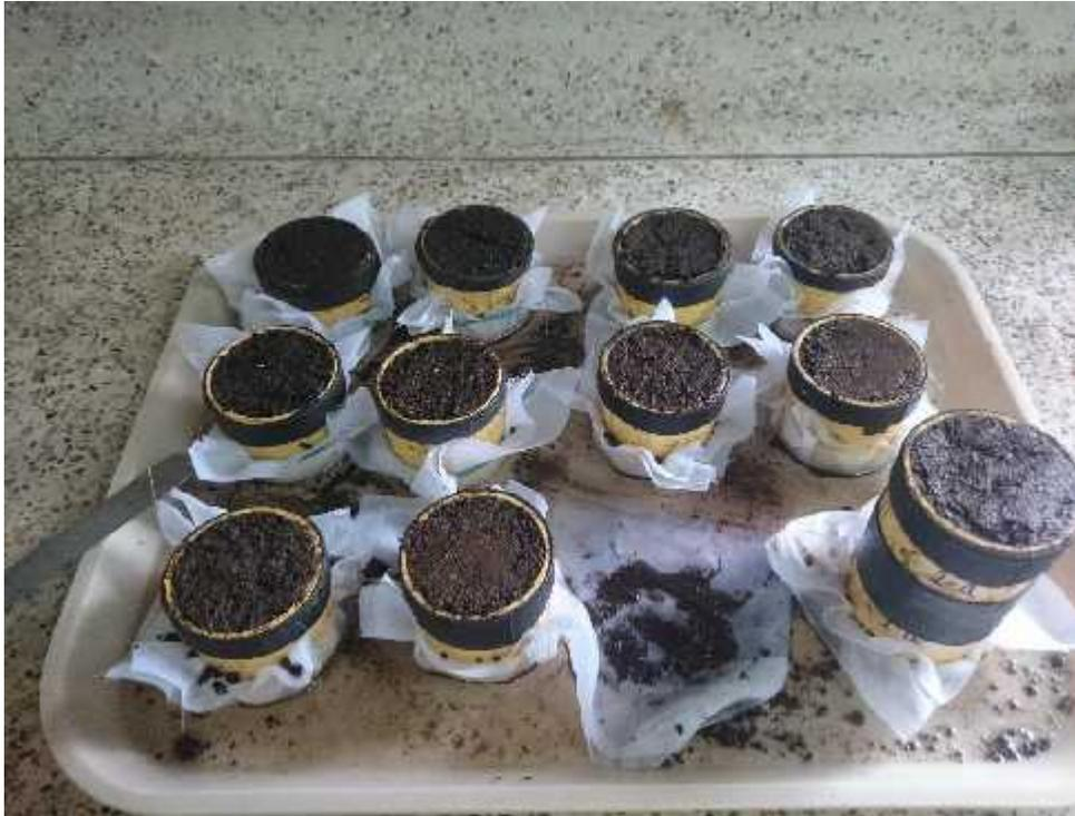
**Figura 6.** Saturación por capilaridad de columnas de suelo sin disturbar
