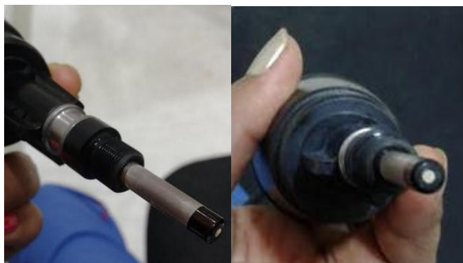
Fig. 10 Electrodo del medidor de oxígeno sin la membrana permeable.
