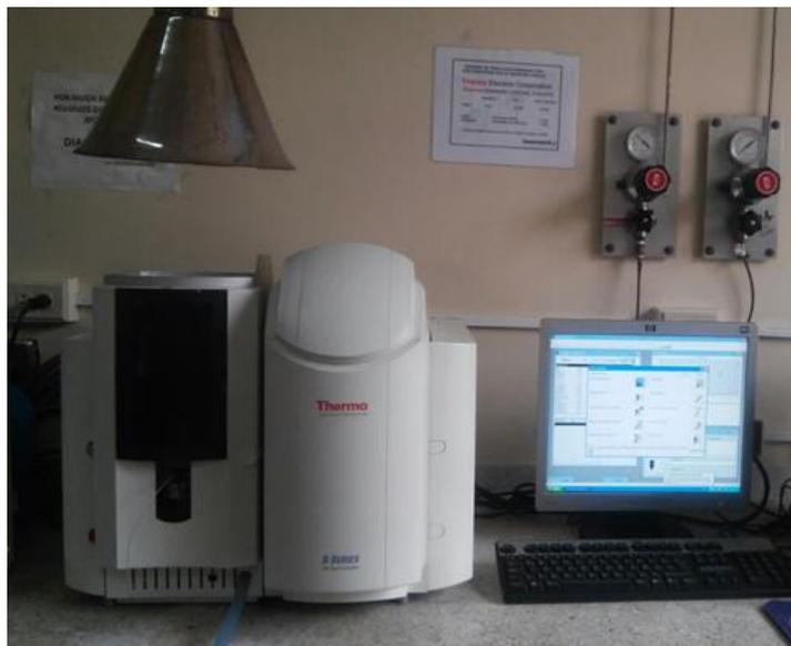
**Figura 9.** Espectrofotómetro de Absorción Atómica Thermo® serie S4SN71203.
