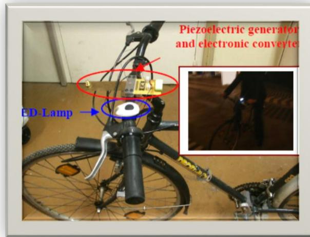
**Figura 5.1** Generador piezoeléctrico instalado en la manilla de una bicicleta para alimentar una lámpara [91].
