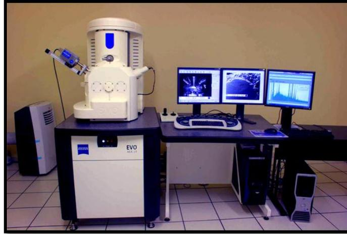
**Figura 2.14.** Microscopio electrónico de Barrido, marca EVO MA15, Carl Zeiss.
