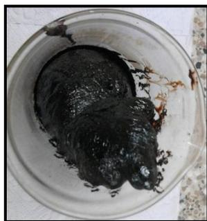
Finalmente, la resina se somete a un proceso de molienda usando un mortero de ágata, con el fin de obtener un tamaño de polvo más fino y se lleva a calcinación a 1000°C, para eliminar restos de material orgánico, agua adsorbida en la resina y favorecer la formación de la fase deseada del material.
