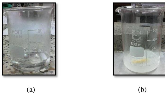
**Figura 2.3** Mezcla de precursores del sistema  $\text{Bi}_{0.5}\text{Na}_{0.5}\text{TiO}_3$ : a) Soluciones 1 y 2; b) Solución final.
