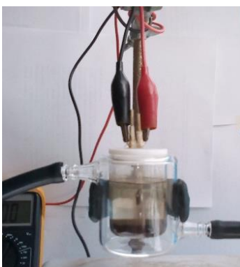
Figura 18. Esquema de la celda para la electroepoxidación de limoneno
