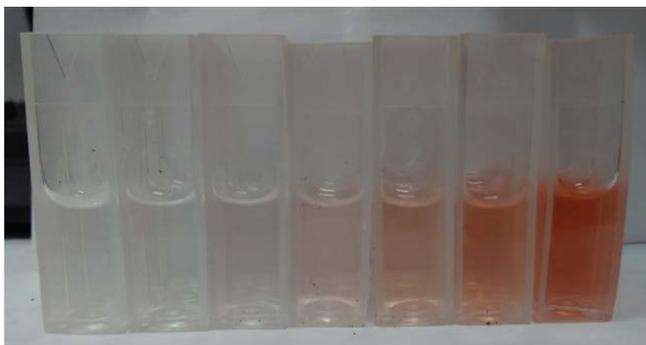
**Figura 29.** Imagen obtenida para la curva de calibración con catequina.
