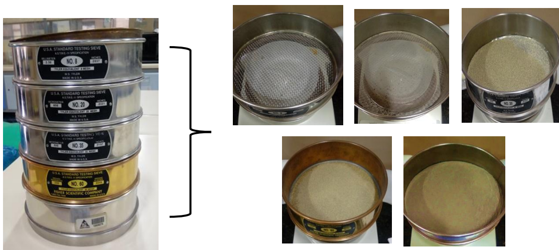
Figura 8. Separación de la muestra en los diferentes tamices
