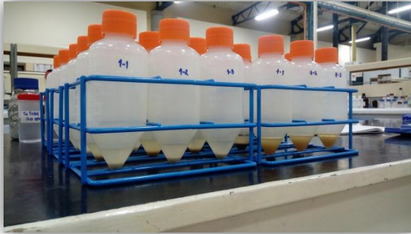
Figura 14. a) Extracción con ácido fuerte, b) Extracción completa Si total
