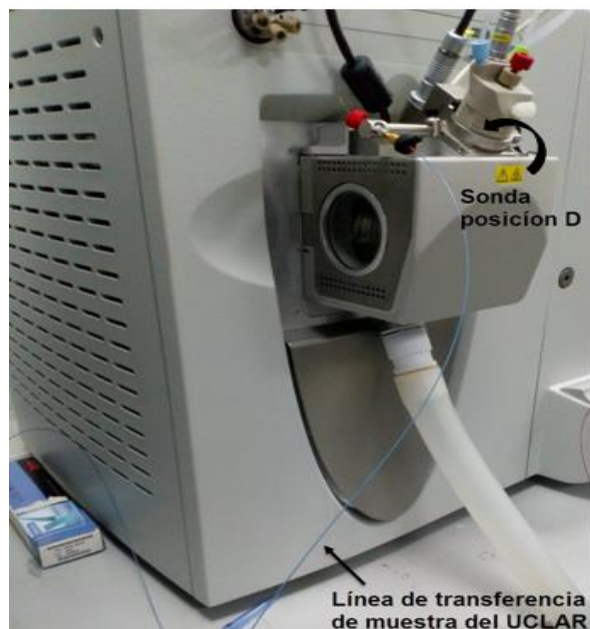
Figura 1. Posición de sonda en D y unión entre el UCLAR y el EM Fuente: Fotografía tomada por el autor en la UAI.
