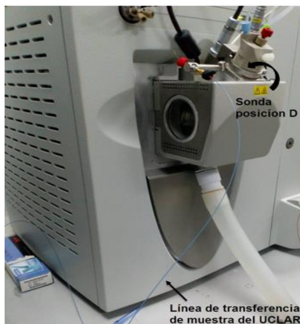
Figura 4. Interfase con línea de transferencia Fuente: Fotografía tomada por el autor en la UAI.
