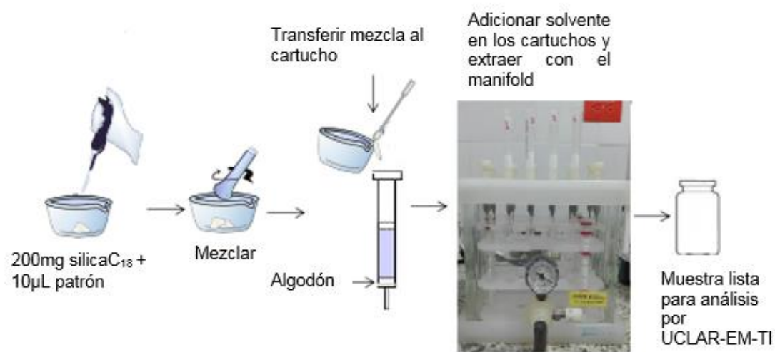
Figura 11. Procedimiento para extracción de citral por DMFS
