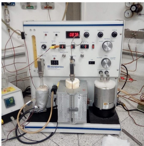
Figura 4: Equipo para los análisis de TPR/TPO (MICROMERITICS ChemiSorb 2720).
