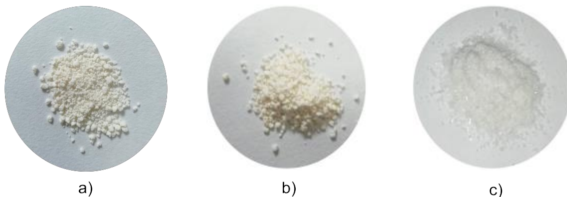
Figura 4. Aspecto físico del TAED: a) grado reactivo (Sigma-Aldrich, \geq 90\% ), b) grado comercial de baja pureza c) recristalizado
