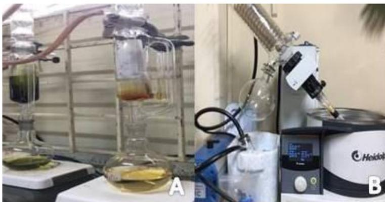
**Figura 9.** A. Montaje de extracción Soxhlet de los metabolitos secundarios de *P. lehmannii*, B. Equipo de rotaevaporación. (Fuente: fotografía tomada por el autor en el laboratorio de QCB, Unicauca).
