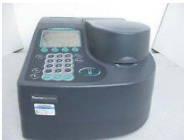
**Figura 47.** Equipo Uv- Vis Genesys 6 utilizado para las lecturas espectrofotométricas de los ensayos de DPPH, ABTS, Fenoles y Flavonoides totales.
