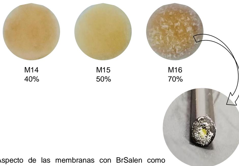
**Figura 30.** Aspecto de las membranas con BrSalen como ionóforo, variando el porcentaje de o-NPOE, entre 40 y 70%.
