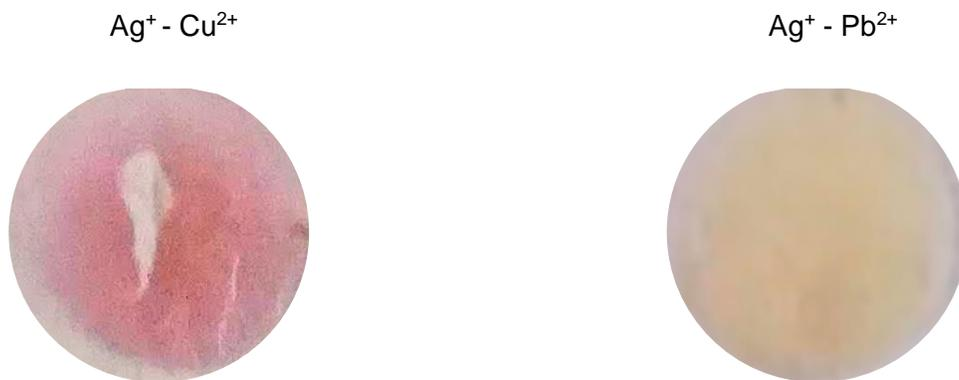
**Figura 36.** Apariencia de las membranas M2 (Salen) después de medir las soluciones de diferente actividad del ion  $\text{Ag}^+$  usando como ion interferente  $\text{Cu}^{2+}$  o  $\text{Pb}^{2+}$ .
