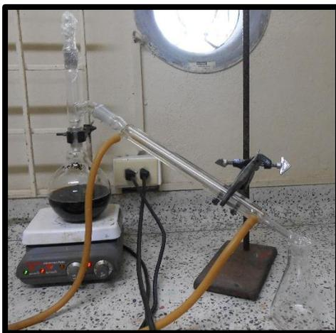
**Figura 6.** Montaje para extracción del aceite esencial de *P. auritum*. Laboratorio del grupo de investigación Química de compuestos Bioactivos. Fotografía: Rengifo, A (2017).
