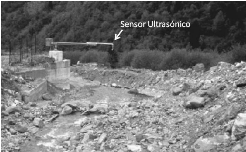
Figura 2.3. Medidor de ultrasonido en el cauce del río [16]
