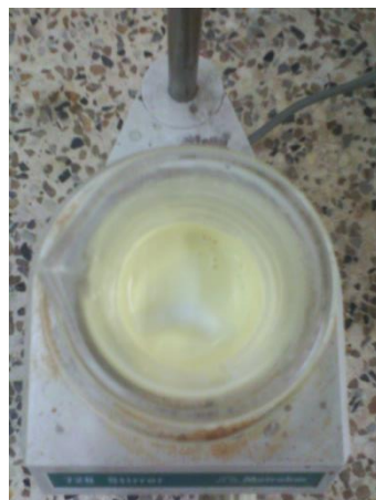
Figura 2.5. Conformación de la barbotina de los polvos de BNT-BFO
