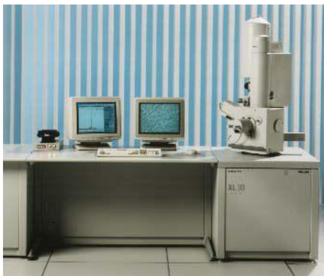
Figura 2.4 Microscopio electrónico de Barrido, marca Philips modelo XL30-FEG.
