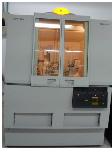
Figura 2.3. Difractómetro X'pertPRO marca PANalytical de la Universidad del valle
