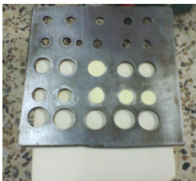
Figura 2.6. Conformación para la formación de las pastillas de BNT-BFO
