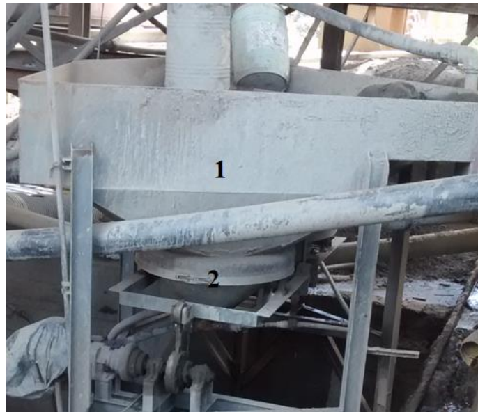
Figura 5. Concentrador Gravimétrico ( jig ). 1. Criba (Mesa), 2. Mecanismo diafragma - polea
