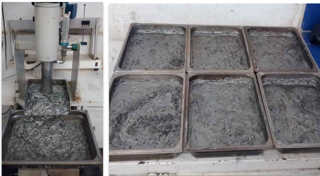
Figura 17. Momentos del proceso de flotación por espuma.
