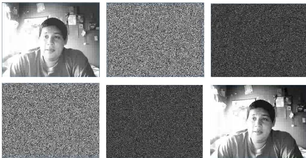
Figura 4.16 Reproducción en tiempo real a  $320 \times 240$  resolución de cámara web, de derecha a izquierda, arriba: reproducción real, máscara real, encriptación. Abajo: máscara falsa, desencriptación con la llave incorrecta, desencriptación con la llave correcta.
