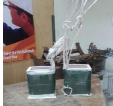
Figura 43. Devanados con material aislante
