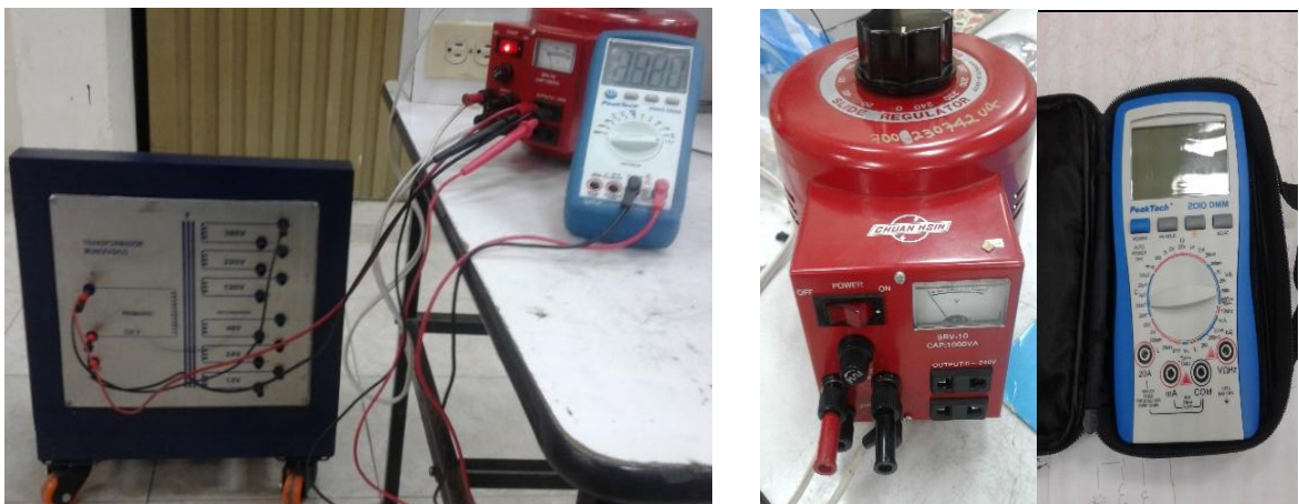
Figura 69. Ensayo de polaridad aditiva y sustractiva, equipos utilizados Variac y multímetro digital
