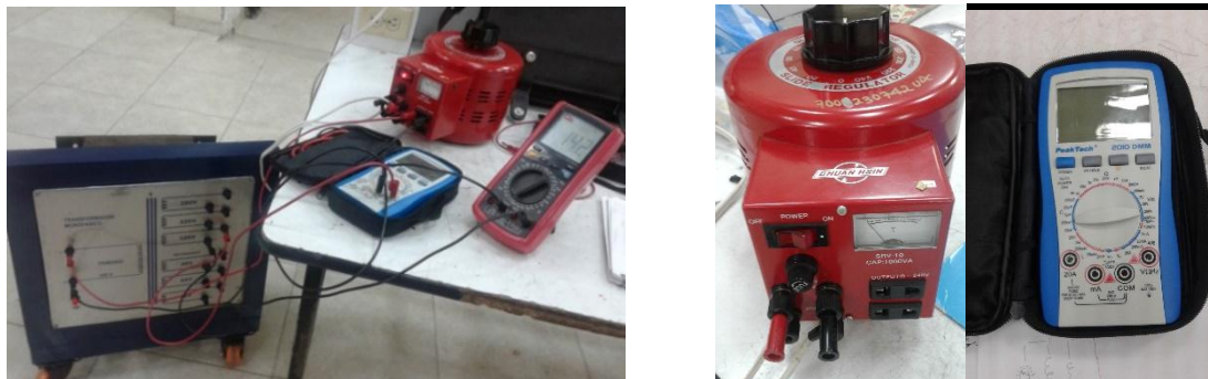
Figura 67. Medida de voltaje de entrada y salida y equipos utilizados Variac, Multímetro digital
