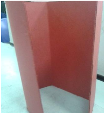
Figura 38. Molde aislante de los devanados
