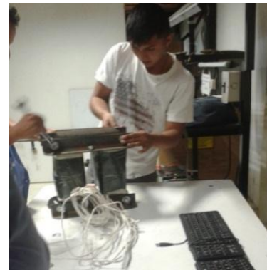
Figura 47. Ajuste del núcleo magnético del transformador monofásico
