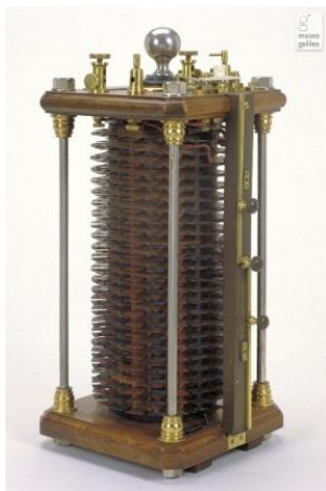
Figura 2. Generador secundario de Gaulard y Gibbs[6]
