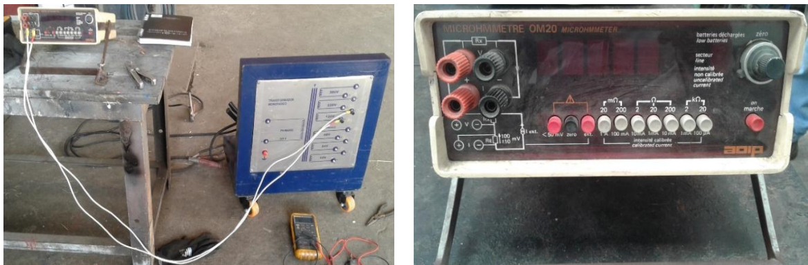
Figura 64. Ensayo de resistencia en los devanados y equipo utilizado Micrómetro OM20
