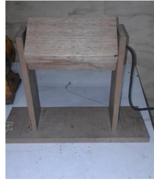
Figura 39. Maqueta para la construcción de los devanados
