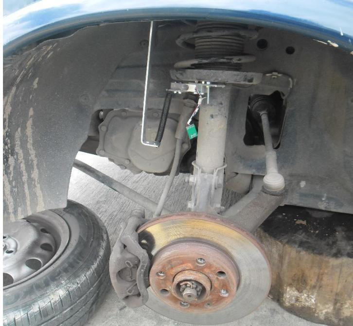
**Figura 4.16** Celda de carga en rueda delantera izquierda.
