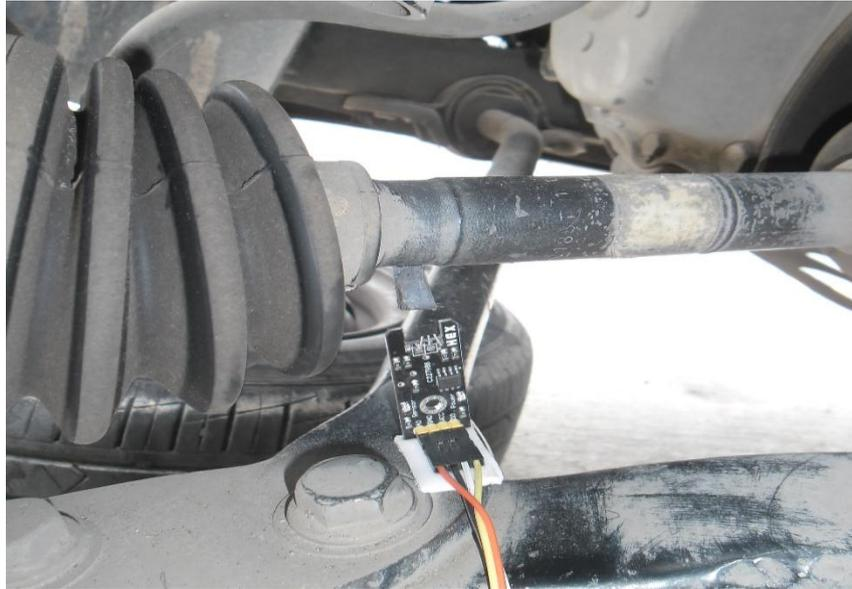
**Figura 4.17** Instalación del sensor de velocidad.
