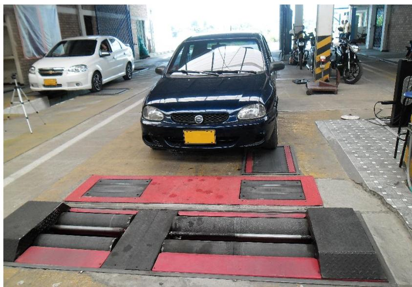
**Figura 4.18** Prueba en frenometro.
