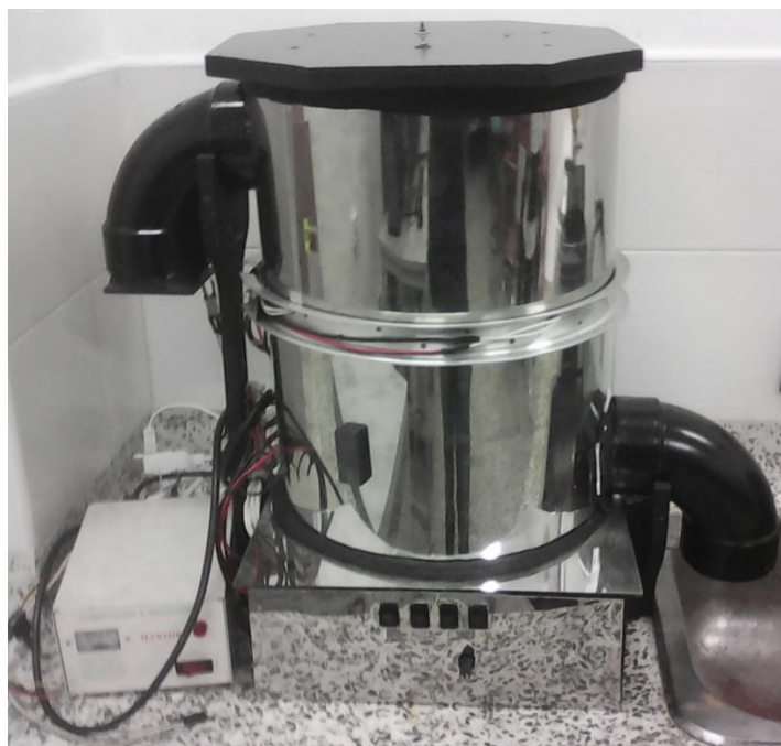
Figura 3.10. Fotografía frontal del fotorreactor ya montado y ubicado en el laboratorio.
