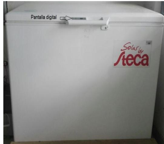
**Figura 4.8 . Refrigerador DC por compresión.**
