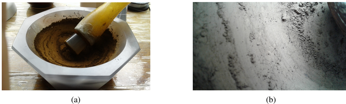
Figura 2.7 Macerado de los polvos \text{WO}_3 precalcinados: (a) mortero de Agata y (b) polvo macerado homogéneo y fino.
