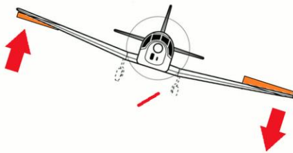
Figura 2.5 Alerones en una aeronave.
