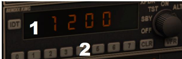
Figura 2.27 módulo de transponder
