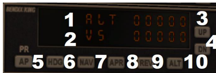
Figura 2.28 módulo de piloto automático.
