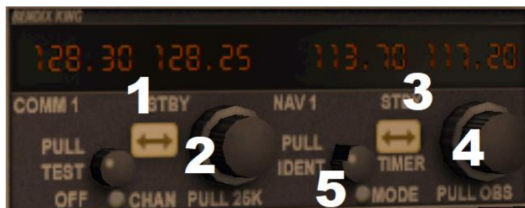
Figura 2.26 módulo de comunicaciones.
