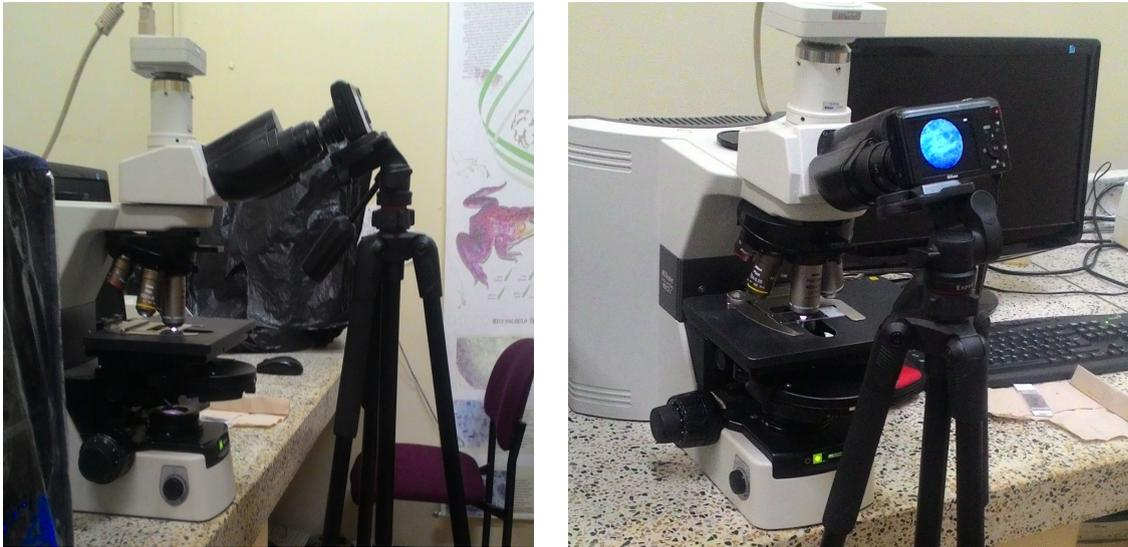
Figura 3.6. Cámara #2, NIKON, COOLPIX S6300. Se observa en montaje con trípode fotografiando directamente al ocular del microscopio.
