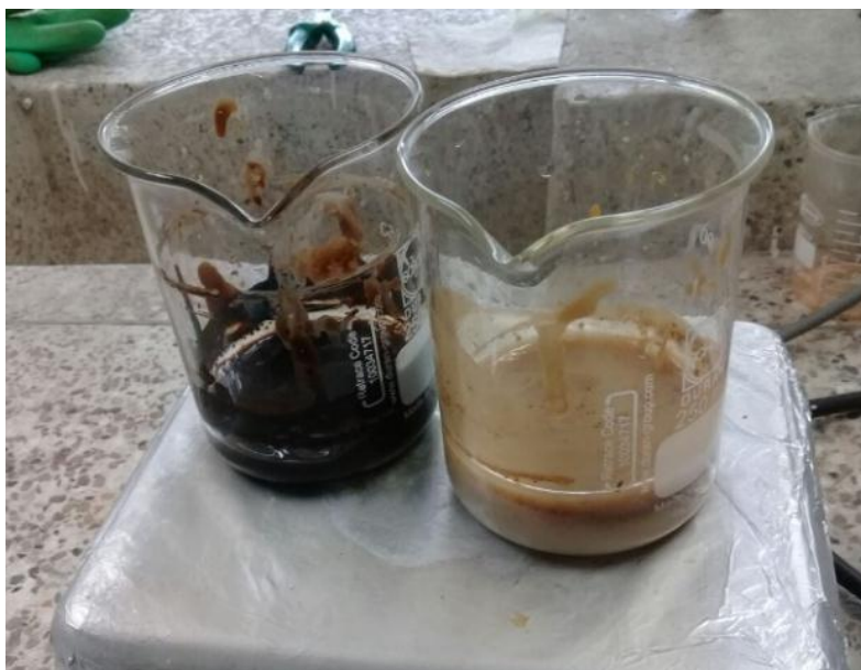
Figura 2.3. Muestras en plancha agitadora. De lado derecho la muestra a pH de saturación sin secar. De lado izquierdo la muestra a pH de equivalencia después de 22 h de envejecimiento.
