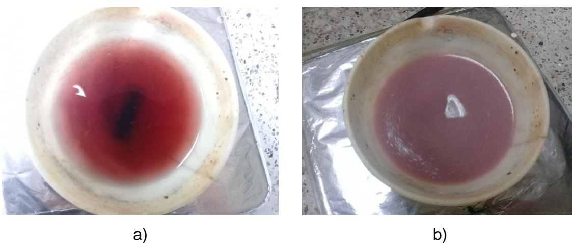
Figura 2.10. Muestra a pH de saturación en plancha agitadora. (a) Muestra a 170^\circ\text{C} (b) Resina formada después de 40 minutos en la plancha.
