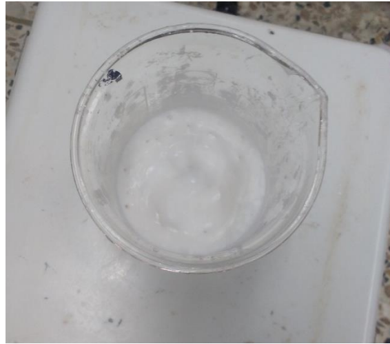
Figura 2.6. Resina obtenida en una de las etapas del proceso Pechini utilizado para sintetizar el CaO.
