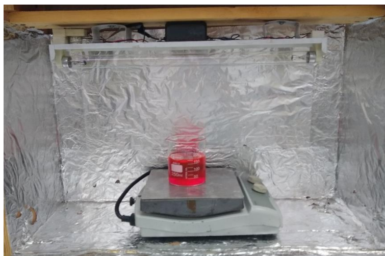
Figura 3.7. Montaje usado para evaluar el efecto de la radiación UV sobre la suspensión de \text{CaO}/\text{Ca}(\text{OH})_2 – rodamina B.
