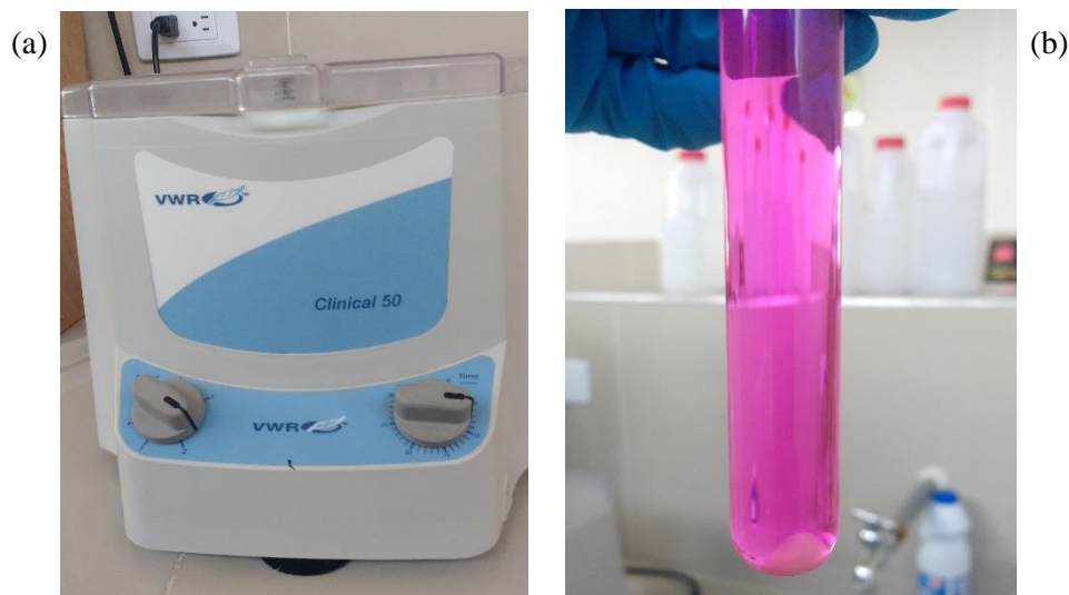
Figura 3.6. (a) Centrifuga CLINICAL 50 empleada para separar las fases sólida y líquida de la alícuota (b) obtenida durante el desarrollo del ensayo, en un tiempo predeterminado.
