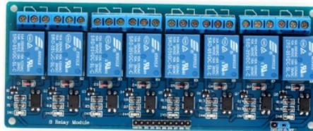
Figura 3.14: Tarjeta de relés de 8 canales
