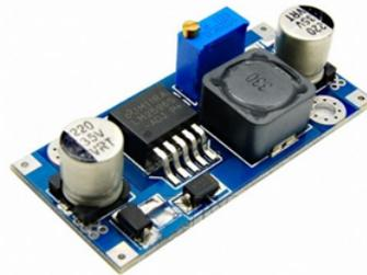
Figura 3.24: Reductor de voltaje DC-DC
