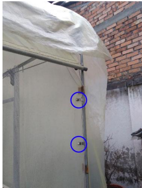
Figura 11. Posición de sensores de efecto Hall.
