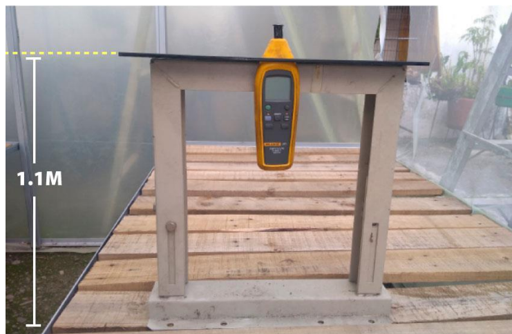
Figura 8. Soporte de sensor de temperatura y humedad.
