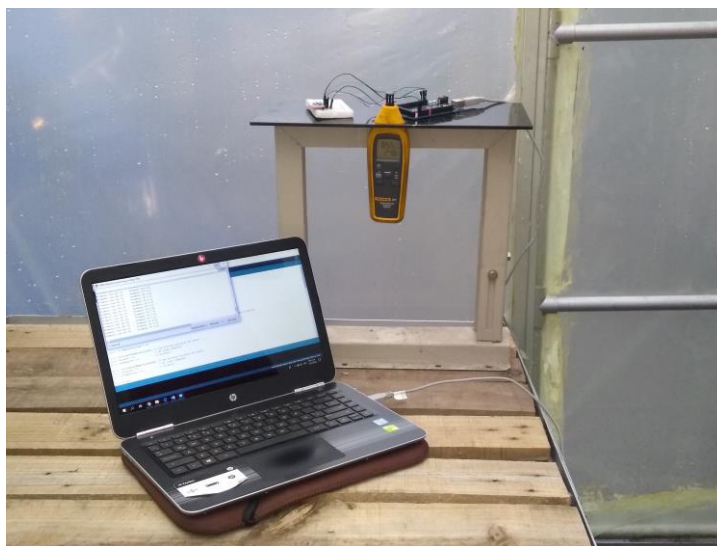
Figura 10. Montaje móvil de medición de temperatura.
