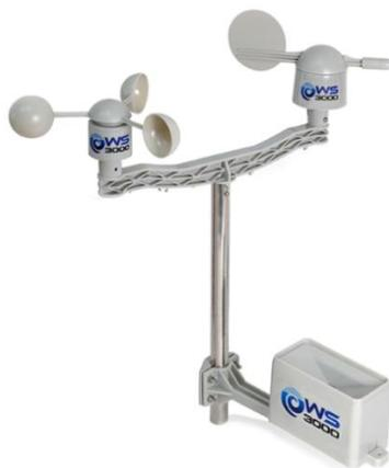
*Figura 15.* Estación meteorológica WS-3000.
