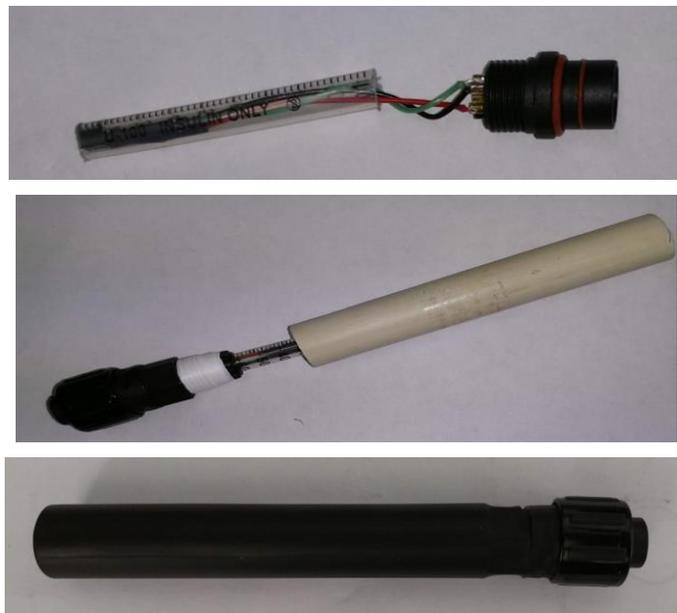
*Figura 22.* Montaje de instalación del sensor de temperatura, estación hidrológica.
