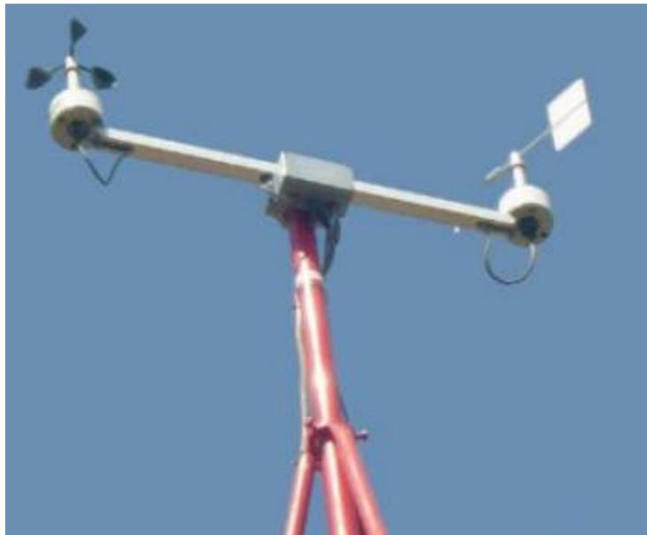
Figura 8 Anemómetro de cazoletas
