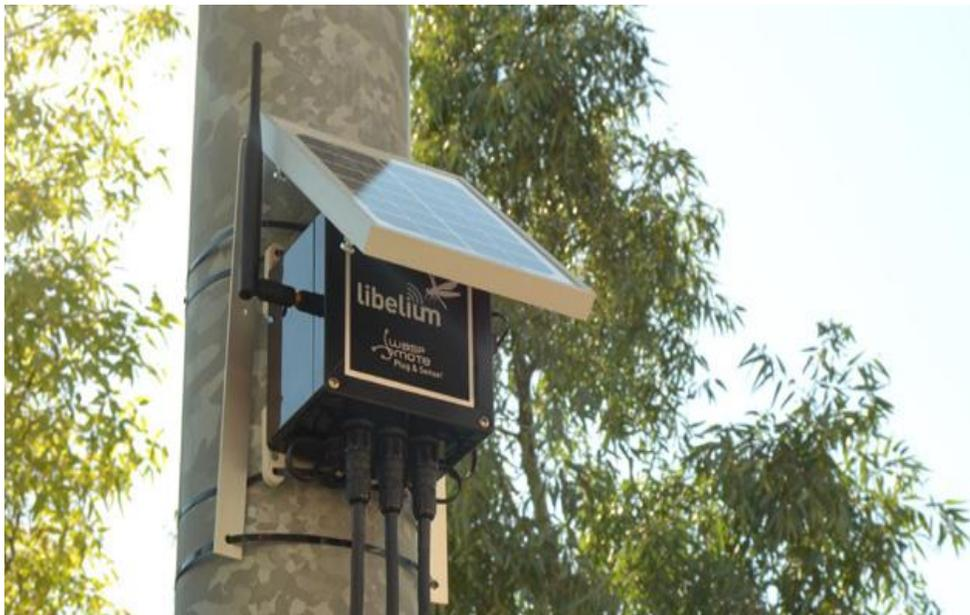
Figura 18. Módulo Smart Agriculture alimentado por un panel solar externo.
