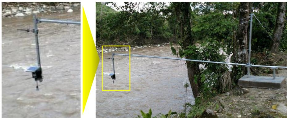
*Figura 26. Instalación de la estación hidrológica.*
