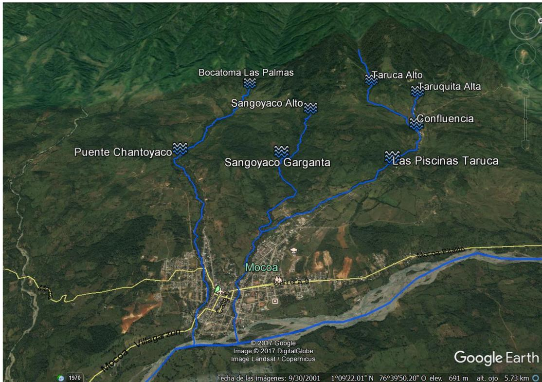
*Figura 10.* Puntos de instalación de estaciones hidrológicas en los afluentes del río Mocoa y que atraviesan la cabecera municipal.
