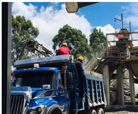
Ilustración 19. Verificación de cargue de triturado
