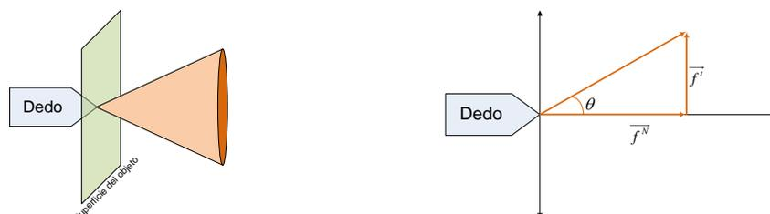
**Figura 6.** Interpretación geométrica de la condición no-deslizante. Adaptado de [7]
