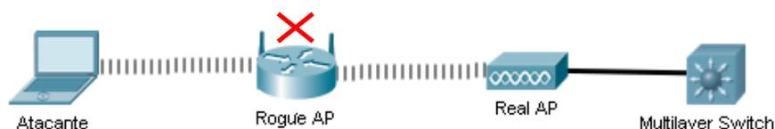
Figura 10. Prueba de penetración interna punto de acceso no autorizado
