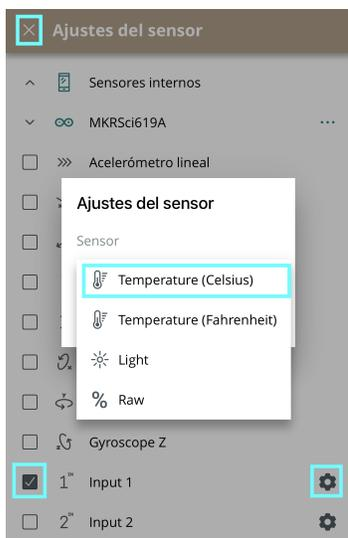
10. Una vez el sensor esté en contacto con el contenedor (como se muestra en el paso 4 de la sección montaje), verifique que el sensor seleccionado es "Input 1" y haga click en el botón grabar. Espere como mínimo 15 minutos para que el sensor registre la variación de la temperatura y pare la grabación.
