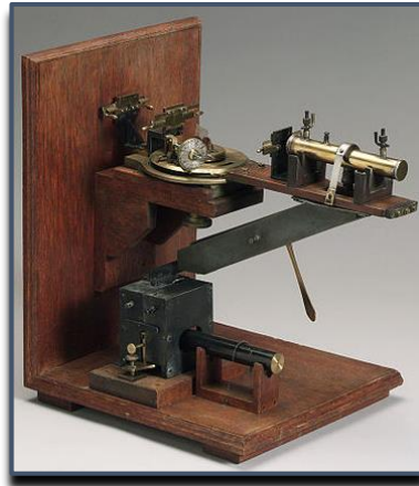
Figura 4.20. Espectrómetro desarrollado por W. H. Bragg en 1912.
