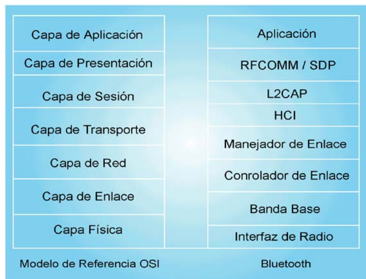
Figura 3.2. Equivalencia entre la pila OSI y la pila Bluetooth
