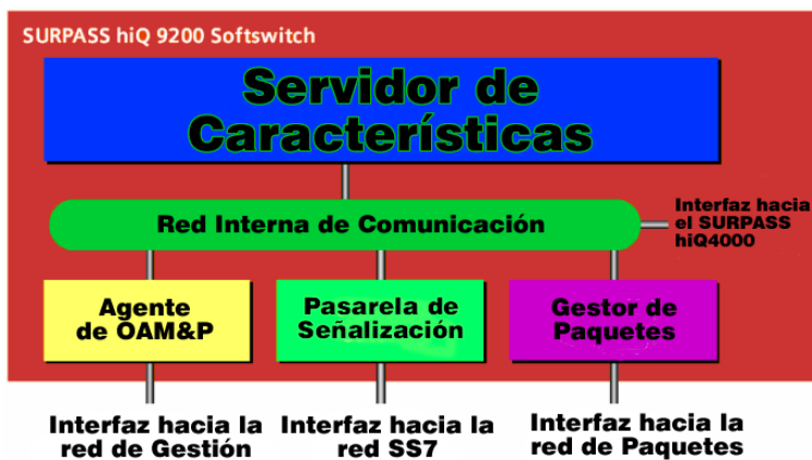
Figura 49 - Arquitectura del Softswitch SURPASS hiQ 9200
